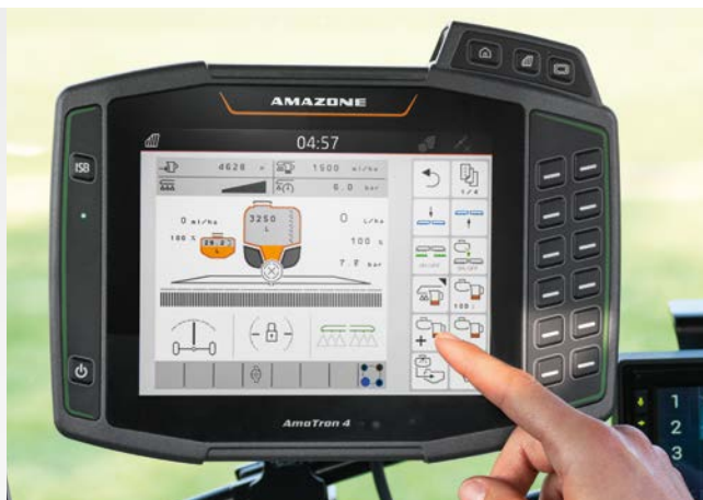
Активация DirectInject на терминалі AmaTron 4
