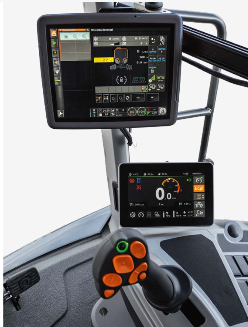
Рішення з двома терміналами: ISOBUS-термінал TopCon X35 і термінал шасі AmaDrive 7.0, а також багатофункціональний джойстик AmaPilot +
