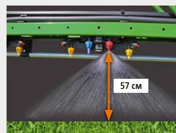
Форсунка 110 ° Відстань між форсунками 50 см
