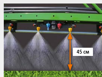
Форсунка 80 ° Відстань між форсунками 25 см
