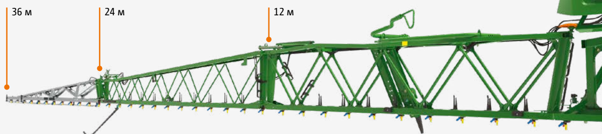
Штанга Super-L3 з шириною захвату 36 м, зі складанням до 24 м і 12 м
