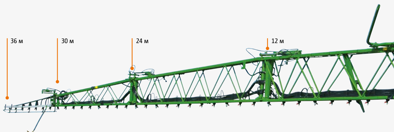
Штанга Super-L2 з шириною захвату 36 м, зі складанням до 30 м, 24 м і 12 м
