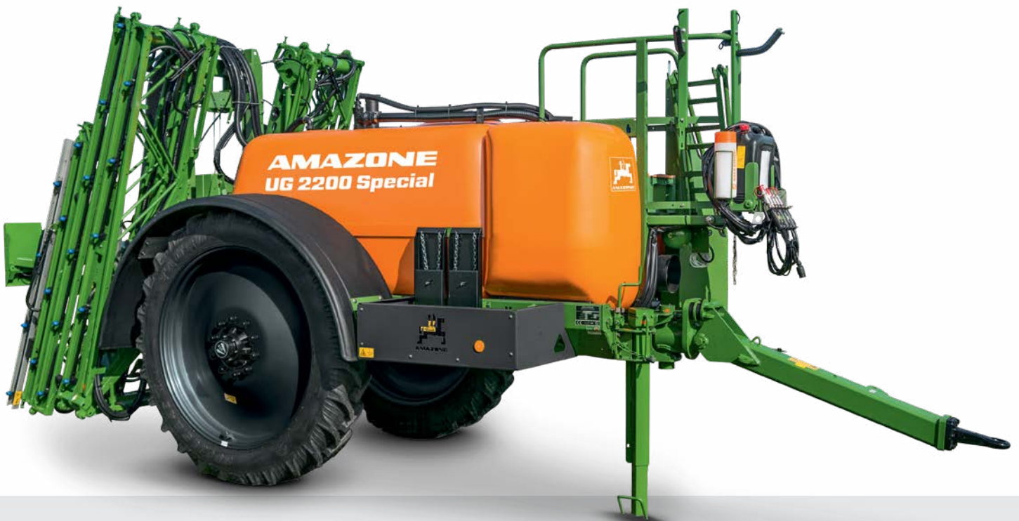
UG 2200 Special зі штангою типу Super-S2 і з шириною захвату 21 м
