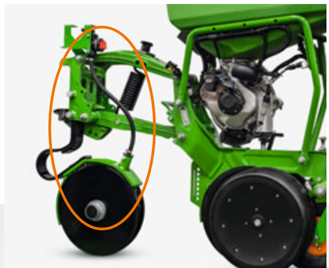
Комплект для рідких добрив на сошнику для внесення добрив FerTeC Twin
