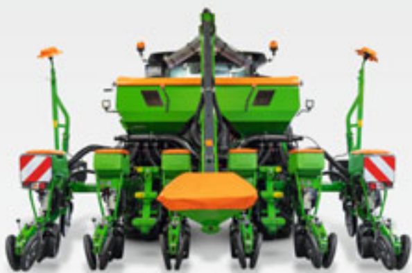
Precea 4500-2CC з телескопічною рамою за повної ширини захвату
