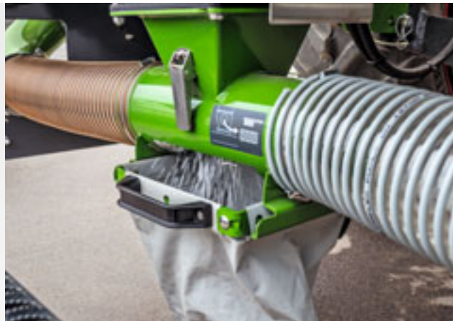
Калібрувальний мішок можна легко закріпити під пристроєм дозування
