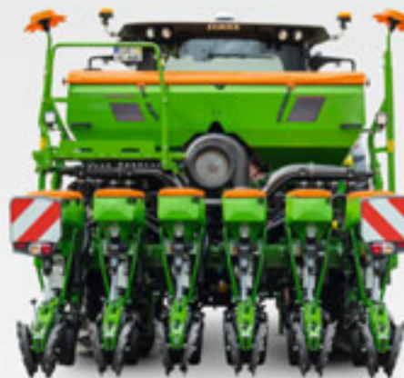
Precea 4500-2CC з варіативною телескопічною рамою для вузької ширини захвату
