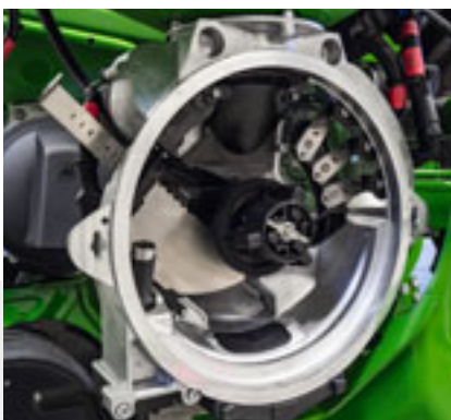
Вигляд дозувального пристрою без висівного диска
