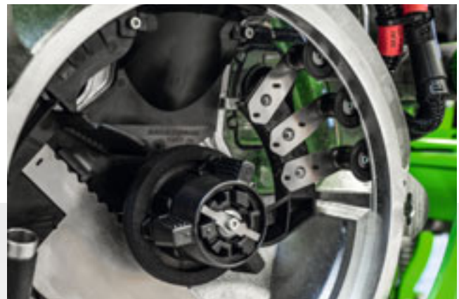
Автоматичне регулювання відсікачів SmartControl здійснює налаштування відсікачів та суттєво полегшує роботу механізатора
