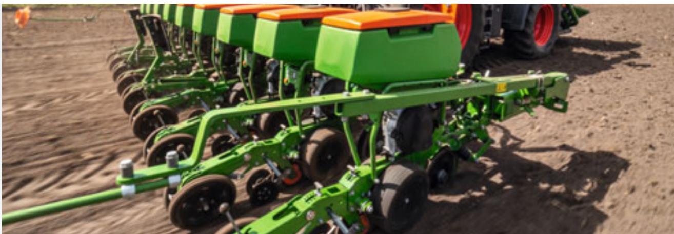
Насіннєві бункери, розташовані над системою дозування
