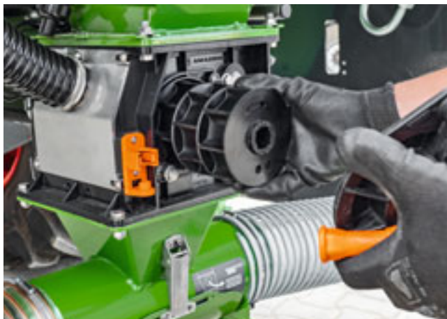
Проста заміна дозуючих котушок на FTender
