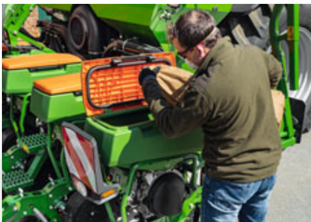
Насіннєві бункери вирізняються зручним доступом і дозволяють користуватися однією рукою
