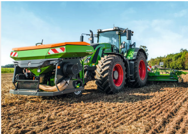
Фронтальний бункер FTender 1600 з об'ємом 1.600 л
