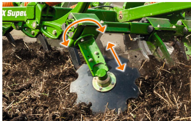
Крайні закриваючі диски – регулюються індивідуально по висоті та куту нахилу
