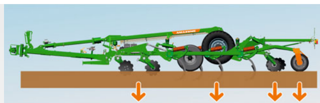
Сeus з батареєю дисків або з секцією стійок в робочому положенні
