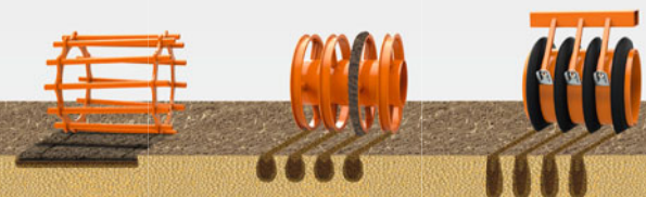
Система пружинних чистиків
