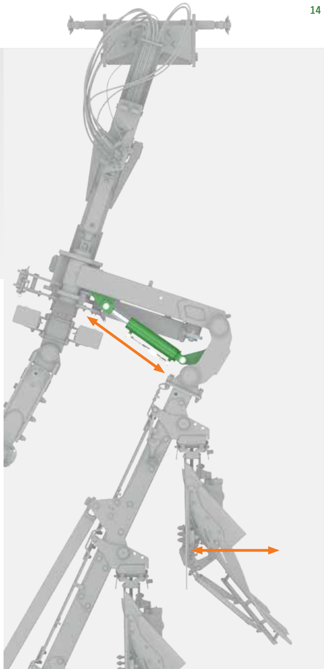
Інтелектуальна кінематична система для регулювання ширини першої борозни
