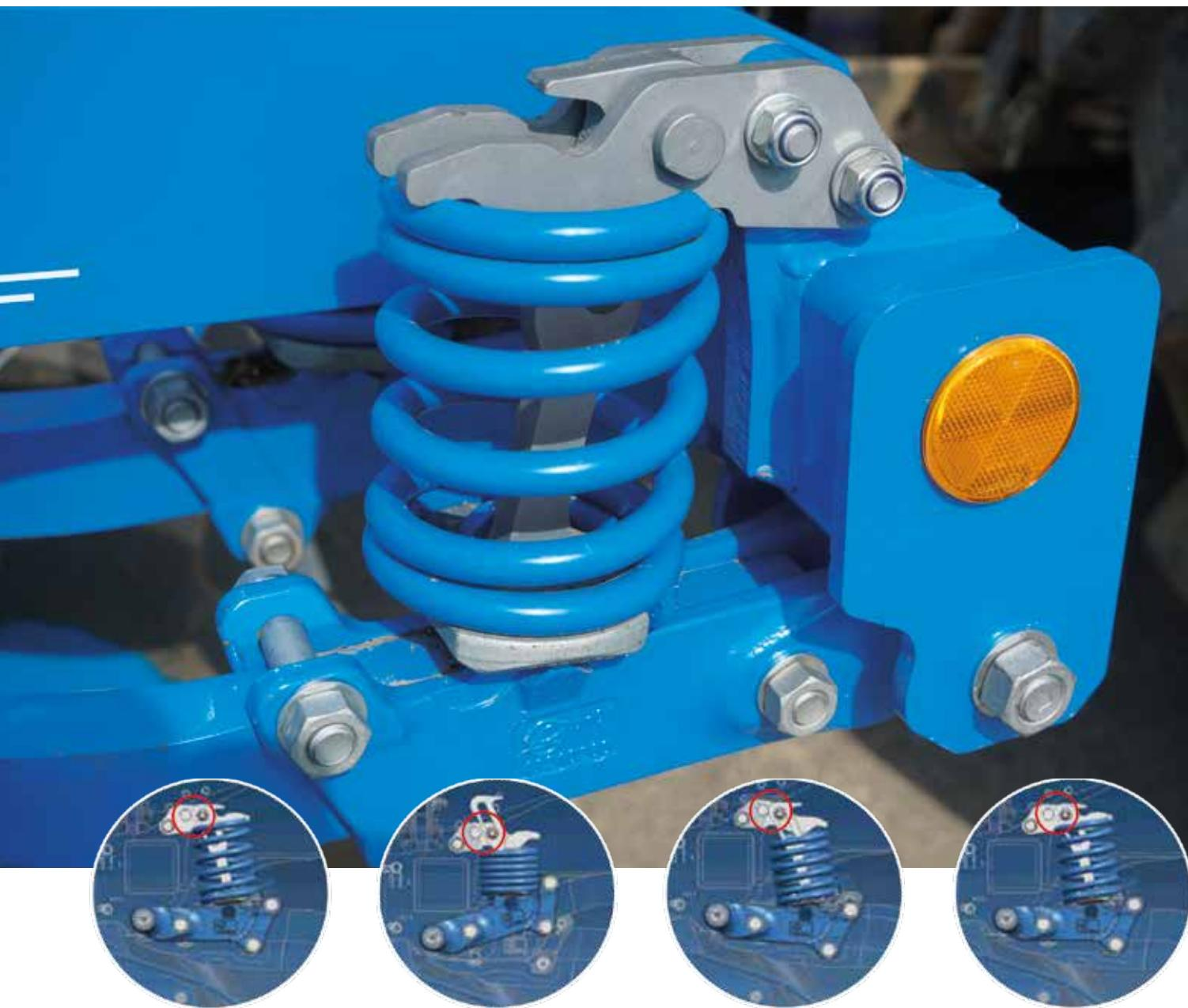
Для подолання перешкод кожен диск окремо підіймається, а потім швидко повертається в робоче положення. Спіральна пружина в вихідному положенні відтискає упор вгору.
