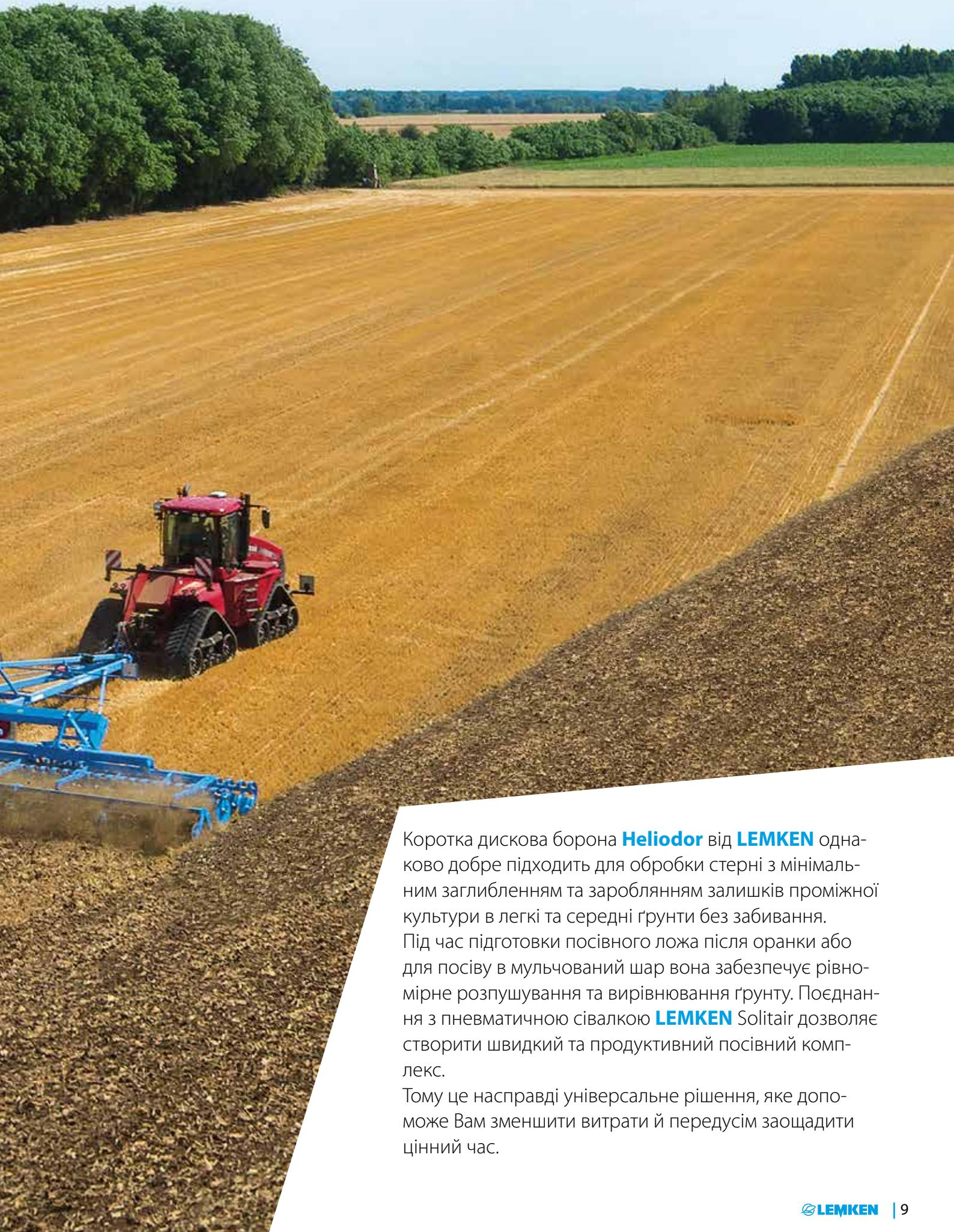
Коротка дискова борона **Heliodor** від **LEMKEN** однією добре підходить для обробки стерні з мінімальним заглибленням та зароблянням залишків проміжної культури в легкі та середні ґрунти без забивання.
