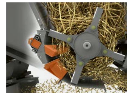
Протиріжучі ножі та терткове днище подрібнювача SPECIAL CUT.
