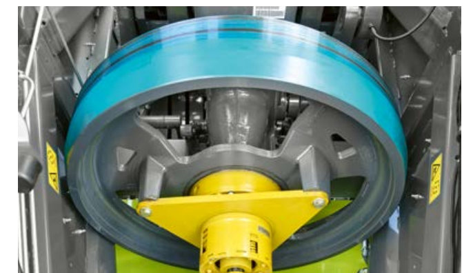
Нова версія маховика: збільшена маса та інерційність для вищої ефективності.
