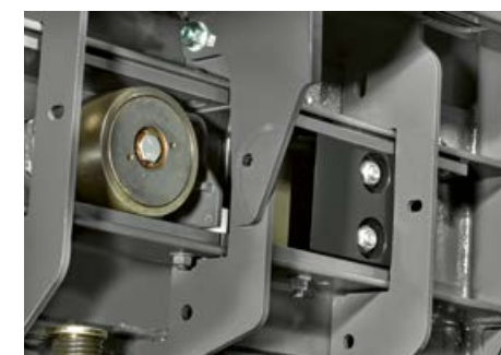
Поворотні ножі можуть установлюватися в двох положеннях для роботи з соломом / кукурудзяною соломом або сіном/силосом.
