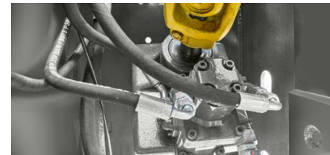
Два оливні насоси подають гідравлічну оливу у вхідний редуктор і систему очищення вузел'язачі TURBO FAN.
