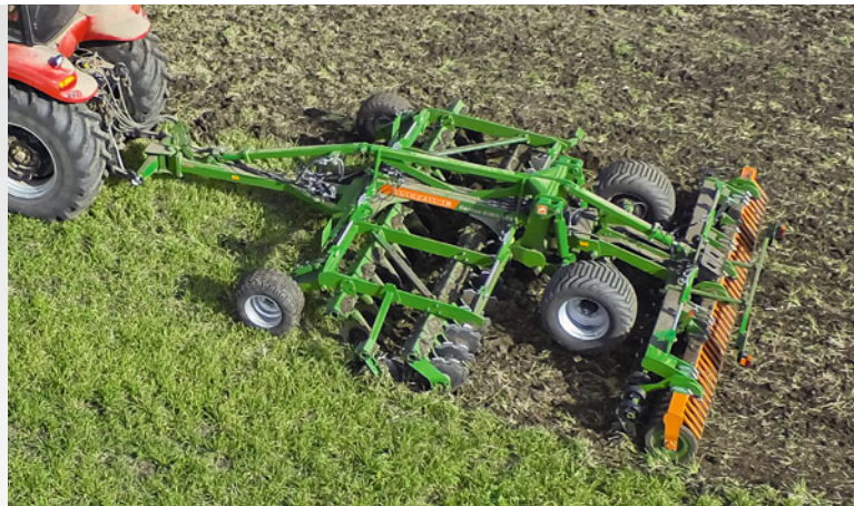
Certos 5001-2TX із шириною захвату 5 м
