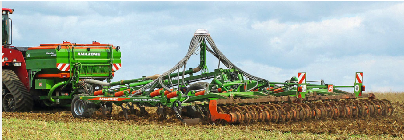
XTender 4200 з культиватором Centius 6003-2TX й однією магістраллю подачі для внесення добрив
