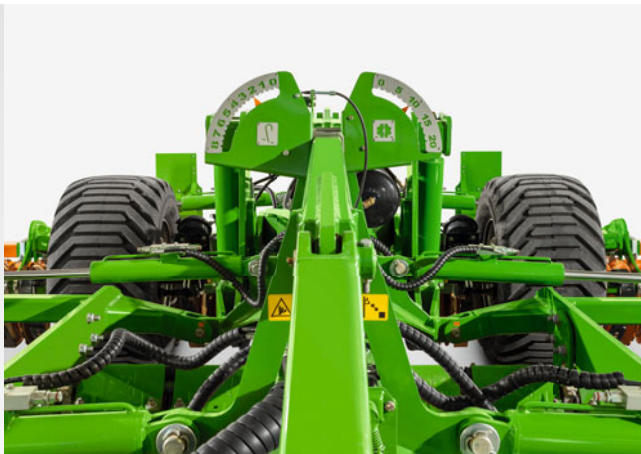
Індикація глибини обробітку вирівнювача Crushboard (зліва) та батареї дисків (справа)
