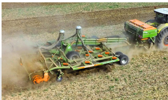
XTender 4200 з культиватором Centius 6003-2TX і двома магістралями подавання для внесення добрив та посівного матеріалу
