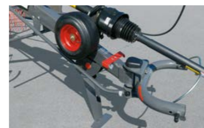
Гнучкі кріпильні скоби з коливанням у поперечному напрямку дозволяють маневрувати під кутом до 80°.
