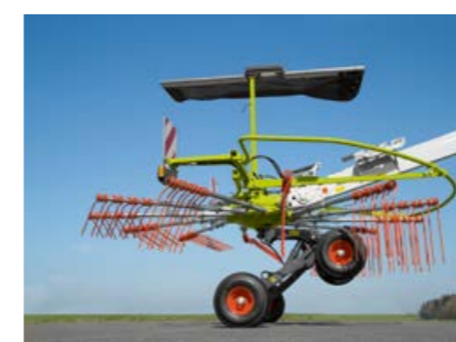
Велика висота підйому для переїзду валків на розворотній смузі: до 50 см у LINER 700 TWIN.
