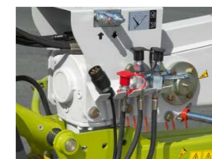
Серійна гідравлічна система послідовного керування для регулювання часу затримки між переднім і заднім ротором під час підйому й опускання.
