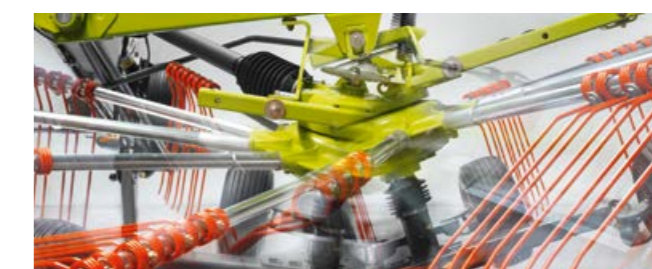
Карданна підвіска роторів: ротори пристосовуються до рельєфу поля — незалежно від трактора.
