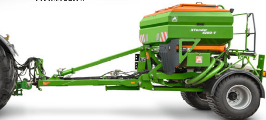
Навісний бункер XTender 2200 з об'ємом 2.200 л
