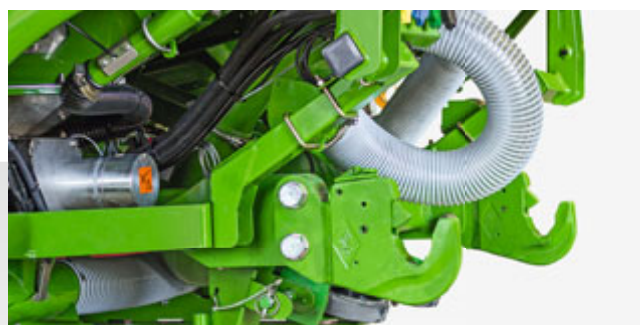
Нижні тяги для агрегування Genius-2TX
