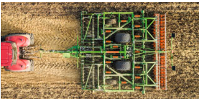
За кожною шиною встановлено стійку для розпушування слідів від коліс
