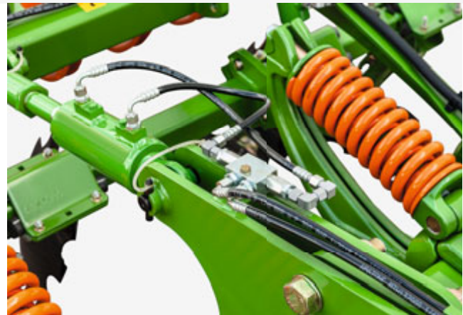
Циліндр для налаштування глибини обробітку ґрунту
