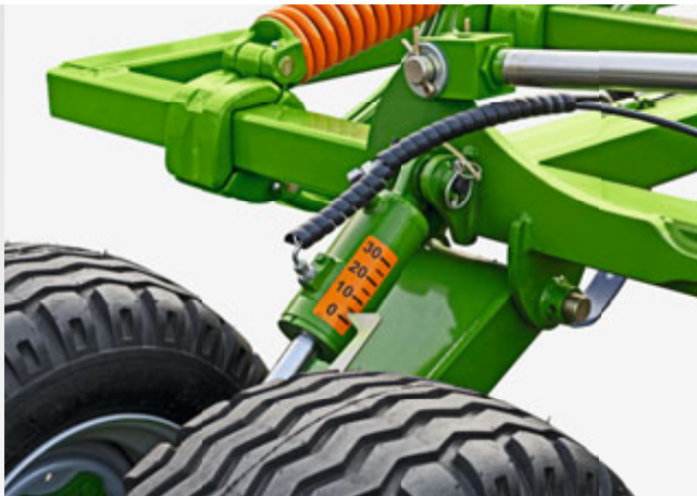
Шкала гідравлічного регулювання глибини обробки стійок
