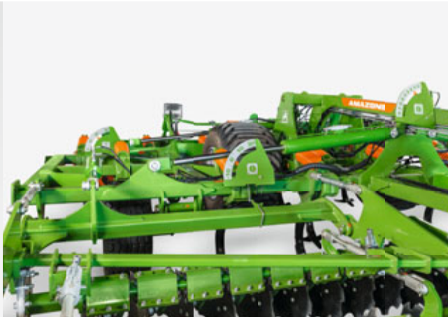
Індикація глибини обробітку трьох одиниць робочих органів
