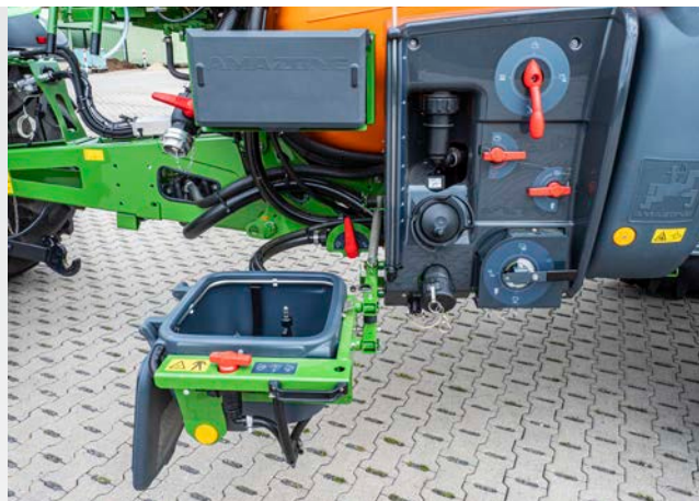
SmartCenter із лівого боку машини з розкладеним промивальним баком
