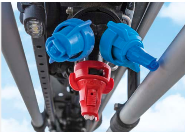
✔ Електричне індивідуальне ввімкнення форсунок AmaSwitch
