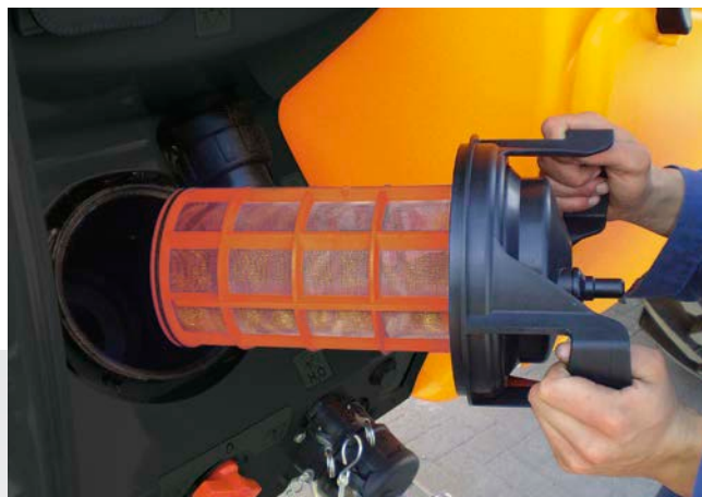
Фільтр грубого очищення можна відкрити й очистити без утрат препарату, якщо машину заповнено.
