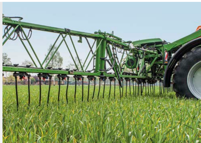
Оснащення шлангами для внесення добрив з AmaSwitch 4-корпусним і комплектом для зміщення на штанзі Super-L2
