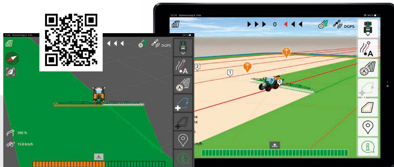
Карти з AmaTron Twin — наочне зображення робочої машини із секціями, а також кнопки з правого боку дисплея планшета
