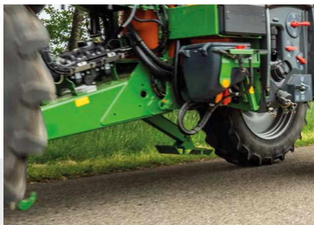
Дишло з нижнім зачепленням і гідравлічною стоянковою опорою
