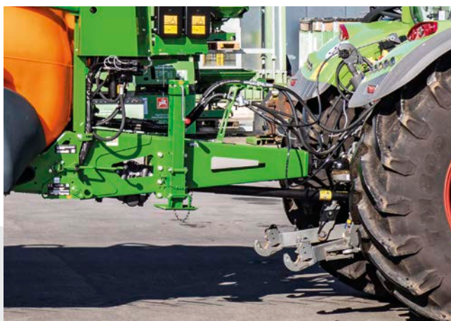
Дишло з верхнім зачепленням із кульовою опорою та механічною стоянковою опорою
