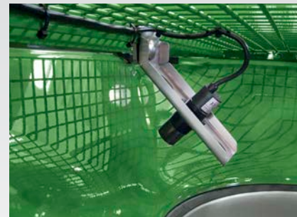
✓ Датчик спустошення бункера на ZA-TS
