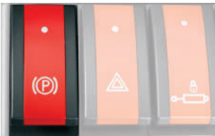
Стоянкове гальмо можна активувати вручну за допомогою тумблера.
