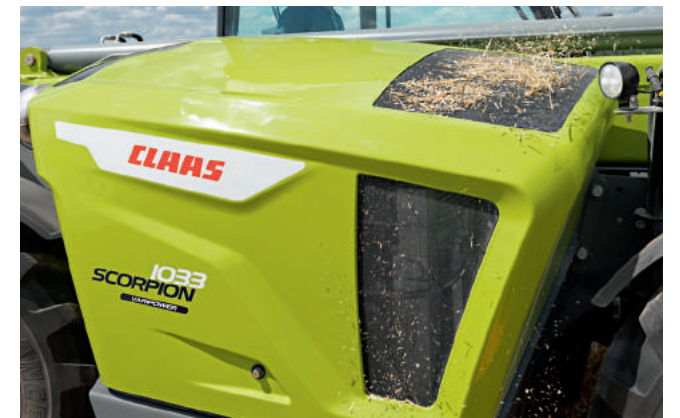
Мінімальне забруднення радіатора завдяки реверсивному вентилятору
