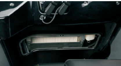
Зручний доступ до фільтра свіжого повітря в кабіні
