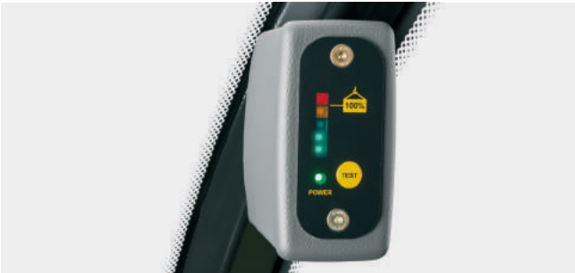
Відображення навантаження зі зрозумілими символами світлофора: якщо межа стабільності перевищена, всі діоди спалахують, і лунає звуковий сигнал.
