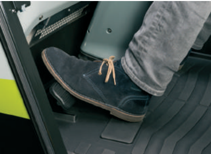
Педаль гальма з функцією сповільненого руху знижує витрату пального та знос гальм.
