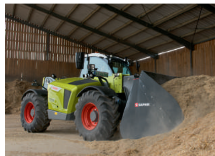
Автоматичне повернення ковша для швидшого виконання робіт поблизу землі
