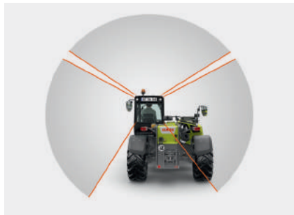
Необмежений огляд ззаду для підвищення безпеки завдяки низькій точці кріплення телескопічної стріли
