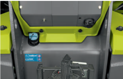
Легкодоступна заливна горловина бака для AdBlue® для ефективної обробки ВГ
