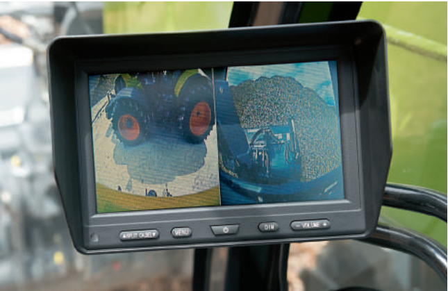
Зображення передньої та задньої камер передаються на монітор у кабіні.
