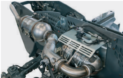
Сажовий фільтр регенерується автоматично.
