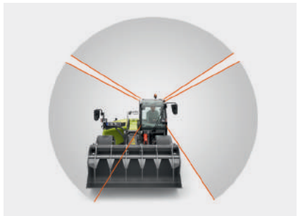
Вільний огляд навісних знарядь і робочої зони
