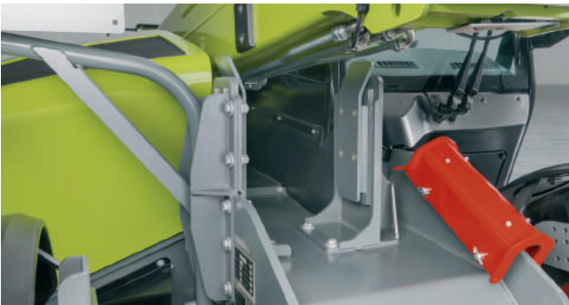
Бічна напрямна телескопічної стріли доступна для всіх моделей SCORPION
