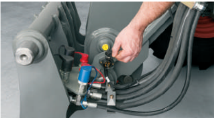
Розетки для гнучкого подання живлення на різні навісні та причепні знаряддя
