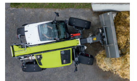
Більше точності за рахунок ручного крабового ходу
