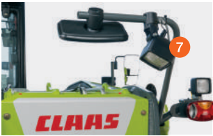
Галогенні фари на утримувачі дзеркала заднього виду для освітлення задньої зони
