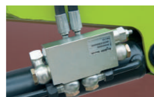
Азотний гідроаккумулятор системи SHOCK ELIMINATOR дозволяє максимально компенсувати різні удари, струси та вібрації.
