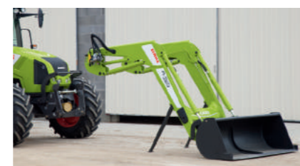
Фронтальний навантажувач CLAAS надійно стоїть на знарядді й опорних лапах.
