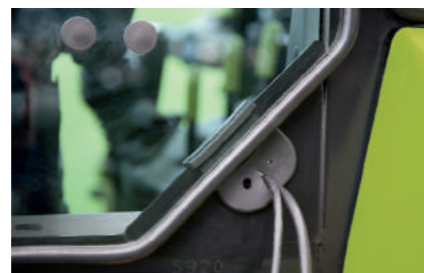
Кабельна проводка на задньому склі допускає використання різних діаметрів майже будь-яких проводів.
