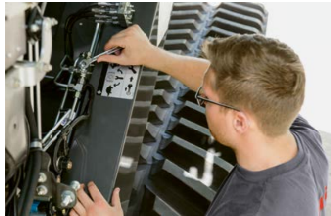
Ручное переключение двух диапазонов частоты вращения редуктора молотильного барабана выполняется с помощью гидравлики.
