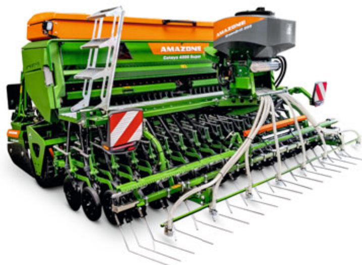
Cataya 4000 Super с шириной захвата 4 м, двухдисковыми сошниками TwinTeC со штригелем Exakt и объемом бункера 1.730 л
