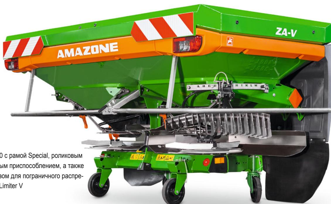
ZA-V 1400 с рамой Special, роликовым стояночным приспособлением, а также устройством для пограничного распределения Limiter V
