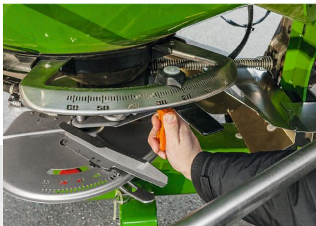
Простая регулировка консоли заслонок с большой шкалой
