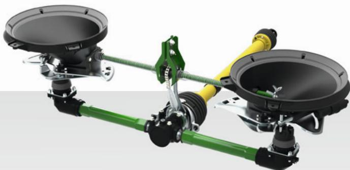
Схематическое изображение распределителя ZA-V с механическим приводом
