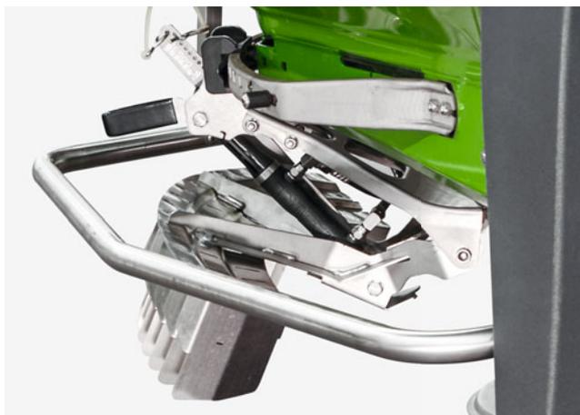
Гидравлическое приспособление для пограничного распределения Limiter V
