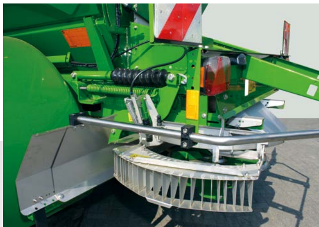
Система межового розподілення Limiter у робочому положенні
