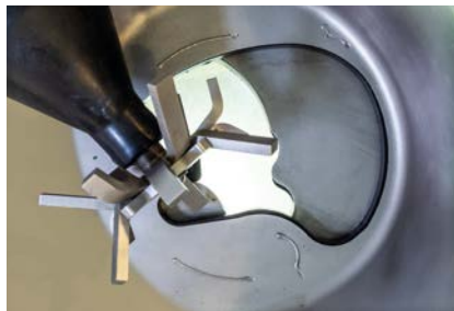
Ступінь 2. Отвір воронки наполовину відкрито
