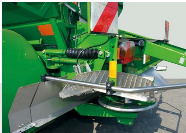
Піднята система межового розподілення Limiter
