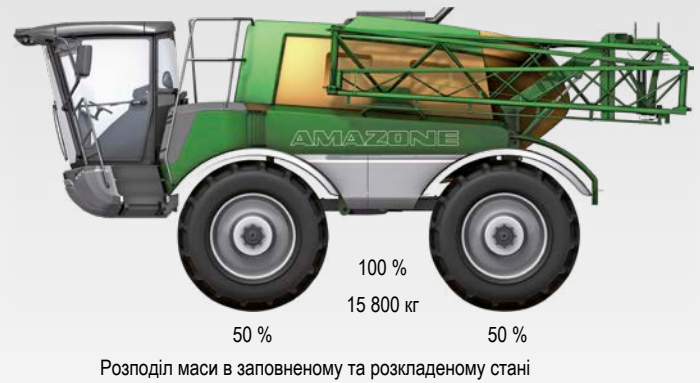
Pantera 4503, 24 м, 520/85R38, маса порожньої машини 9850 кг
