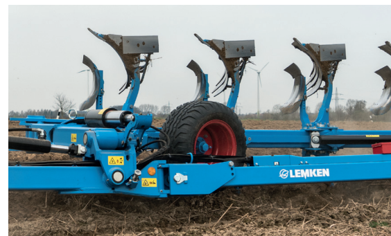
Регулировка горизонтальной точки приложения тягового усилия (опция для исполнения OF)
