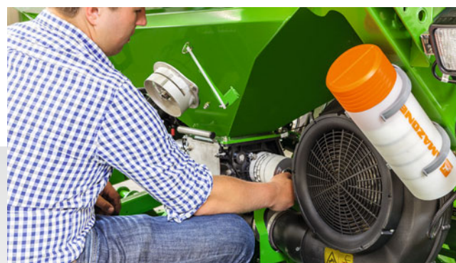
Удобный доступ к дозирующим катушкам облегчает их замену
