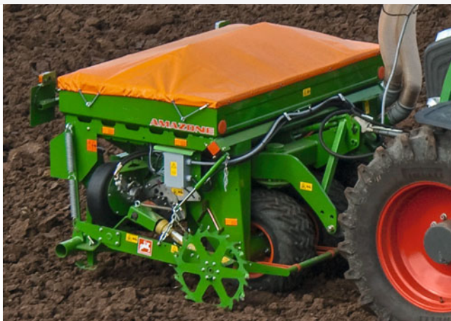
Двухсекционный фронтальный бункер на Avant шириной 6 м с механическим приводом дозирования через приводное колесо для двух распределительных головок
