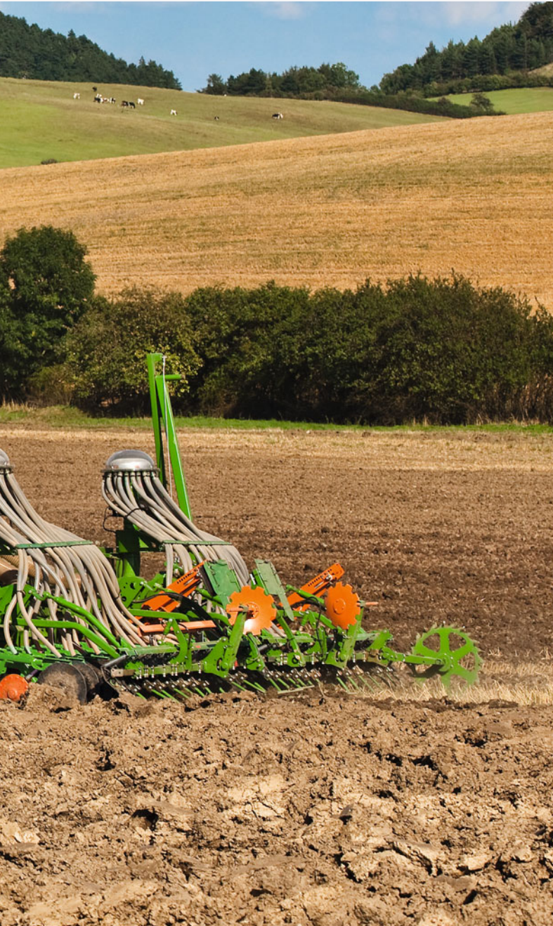
Посевная комбинация Avant с фронтальным бункером, ширина захвата 6 м
