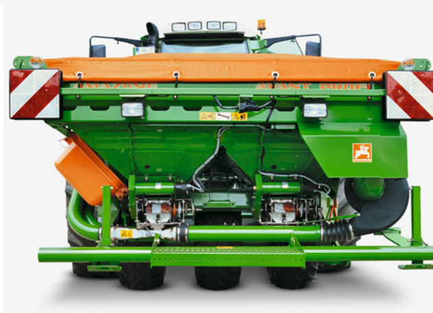
Двухсекционный фронтальный бункер на Avant шириной 6 м с двумя сервоприводами дозирования для двух распределительных головок
