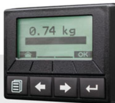
❸ «При наличии терминала TwinTerminal не нужно лишний раз заходить в кабину при калибровке».
