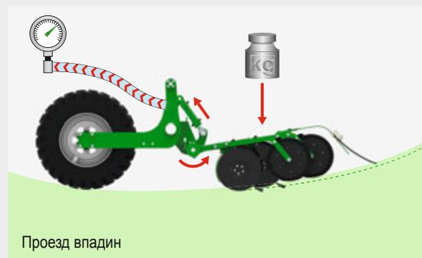
**Впадина:** При проезде впадин сошники дополнительно вдавливаются в почву. Это создает повышенное давление в цилиндре давления на сошник, которое подается обратно непосредственно в циркуляцию масла. Давление на сошник остается неизменным.
