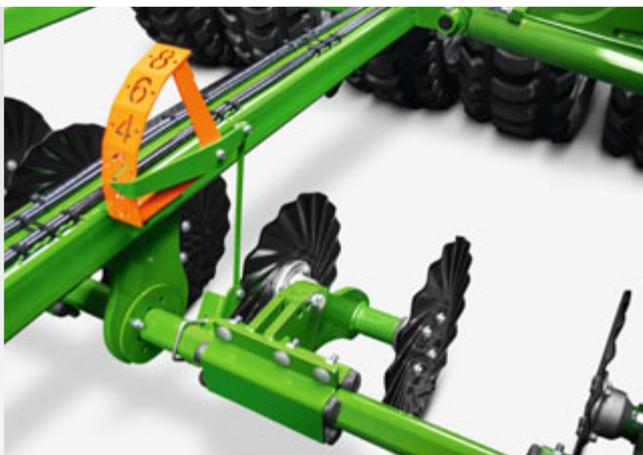
Гидравлически регулируемая батарея дисков с четкой шкалой обеспечивает простое использование батареи дисков
