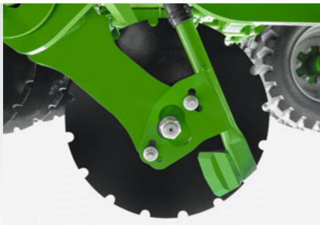
Однодисковый сошник FerTeC перед шинным пакером
