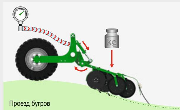
**Бугор:** При проезде бугров сошники опускаются и формируется пониженное давление в цилиндре давления на сошник, которое сразу же выравнивается за счет дополнительного масла. Давление на сошник остается неизменным.
