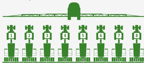
Сеялка 3,50 м: Пример, система технологической колеи 28 м
