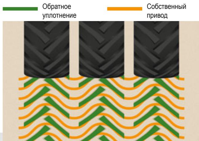
Обратное уплотнение с шинами AS: По сравнению с шинами Matrix шины AS обеспечивают более простую картину работы. Хорошая альтернатива для не очень чувствительных регионов.
