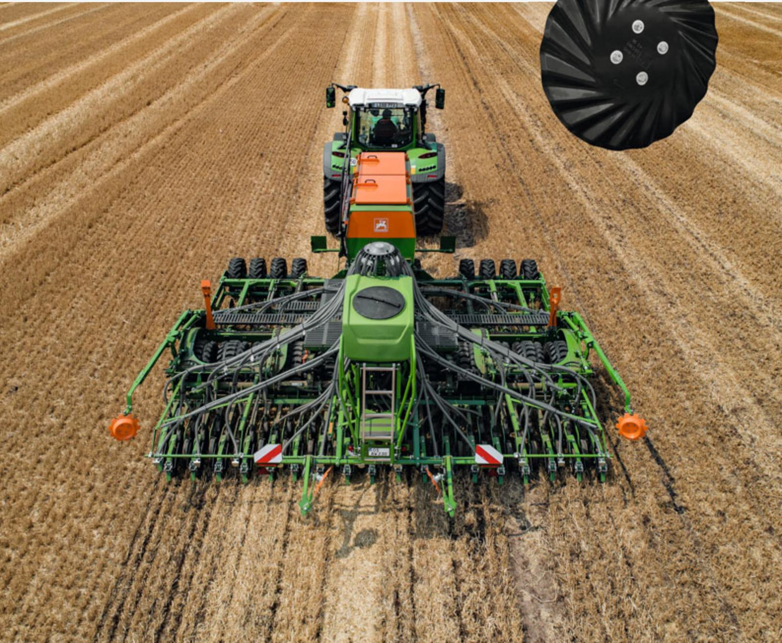
Минимальная и влагосберегающая обработка почвы за счет полосовой обработки рифлеными дисками Minimum TillDisc
