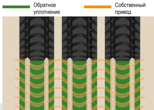
Обратное уплотнение с шинами Matrix: За счет полосового обратного уплотнения шин Matrix формируется оптимальное состояние почвы, которое адаптируется к актуальным погодным условиям и способствует быстрому и равномерному появлению всходов. Шины формируют неоднородную структуру почвы.
