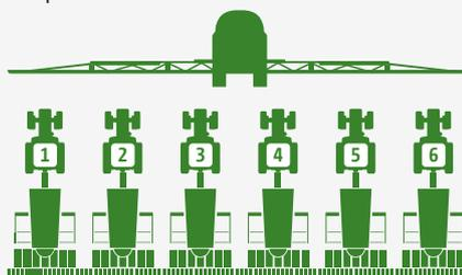
Сеялка 3,50 м: Пример, система технологической колеи 21 м
