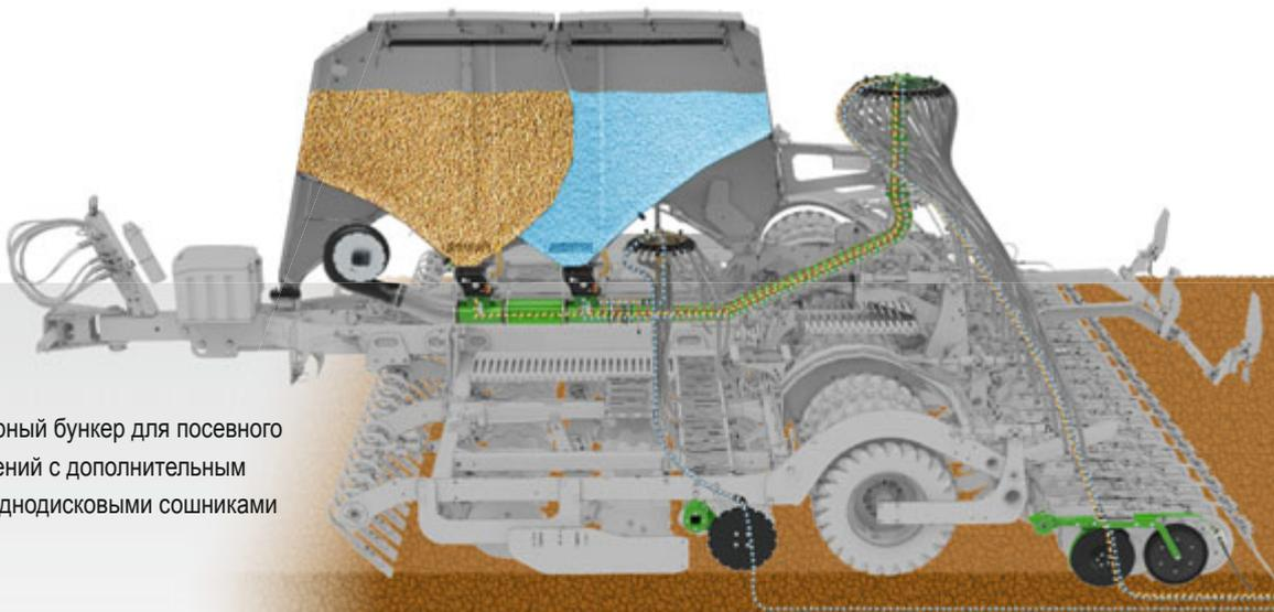
2-секционный напорный бункер для посевного материала и удобрений с дополнительным каналом подачи и однодисковыми сошниками FerTeC
