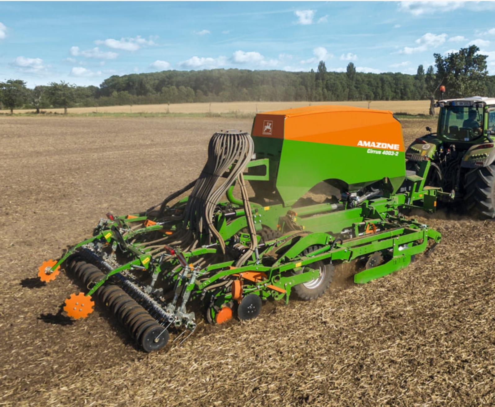
Для регулировки дозирующего устройства скорость движения Cirrus может определяться через радарный сенсор, сигнал GPS или альтернативно через скорость трактора.
