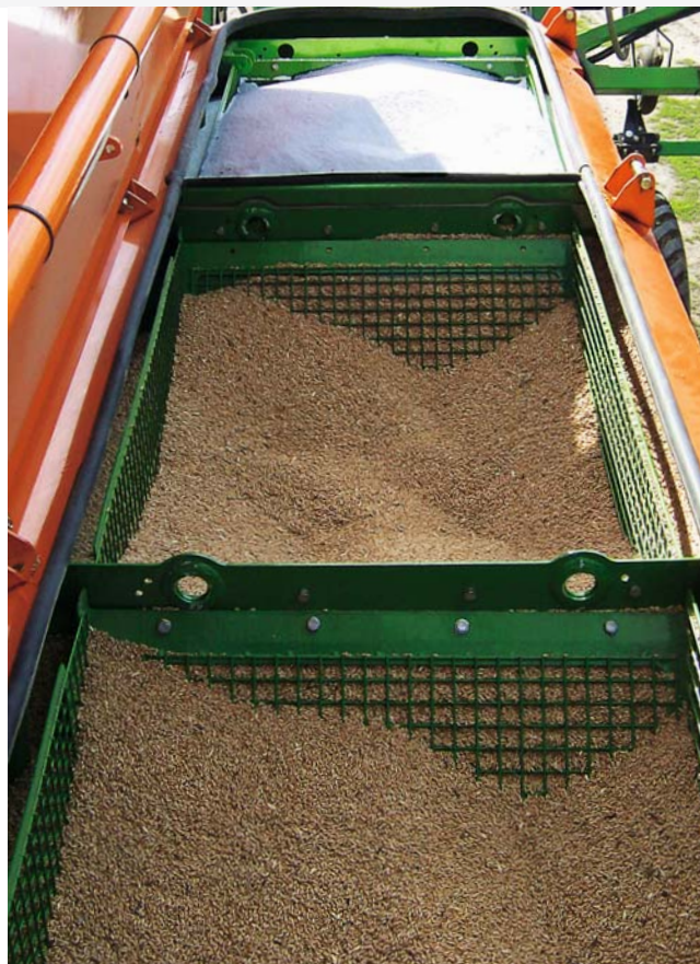
3-секционный напорный бункер на Citan 12001-C и 15001-C
