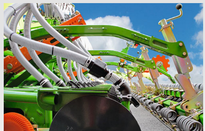
Датчик для фиксации потока посевного материала на высевном сошнике
