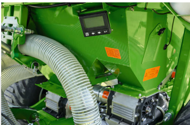
Primera DMC с сервоприводом дозирования и терминалом TwinTerminal
