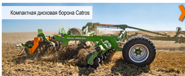
2-й проход: глубина обработки 5 см
