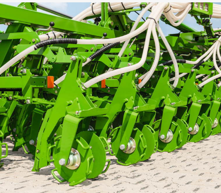
Параллелограммная подвеска долотовидных сошников
