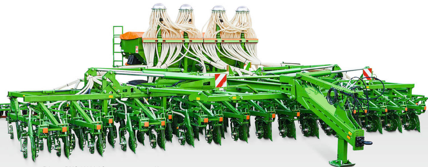
Primera DMC 12000-2C, ширина захвата 12 м
