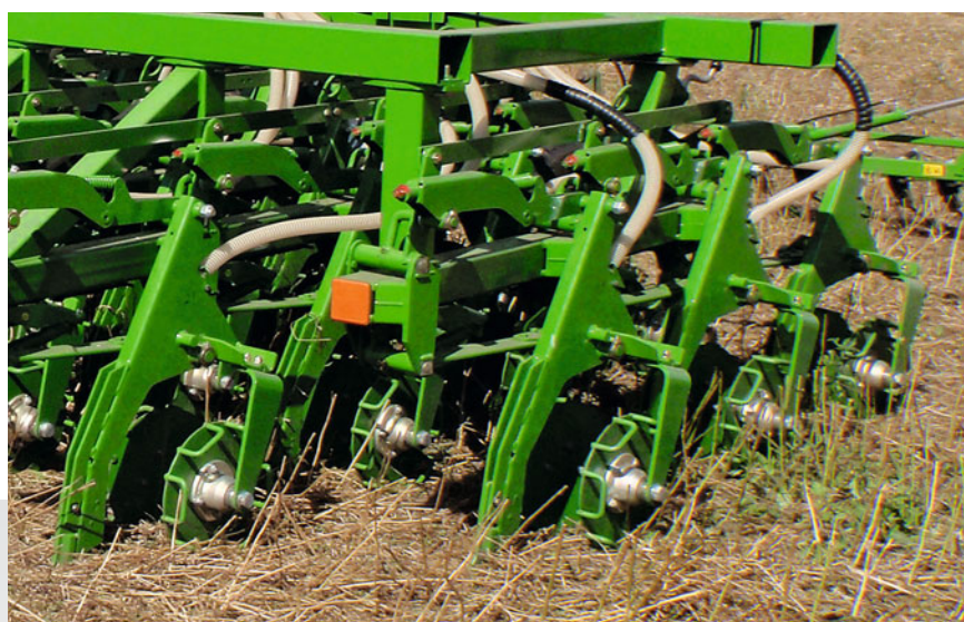
Рамочный каток для мульчированного и прямого посева
