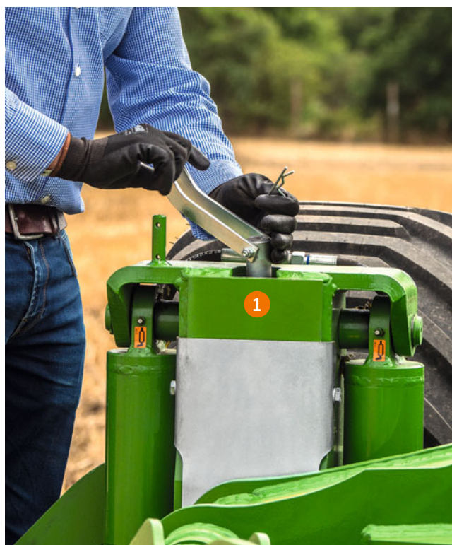
Налаштування глибини обробітку біля опорно-транспортного колеса
