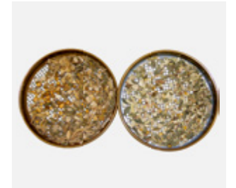
Ситовой анализ технологии SHREDLAGE® с высокой интенсивностью обработки зерна справа и традиционной технологии обработки силоса слева
