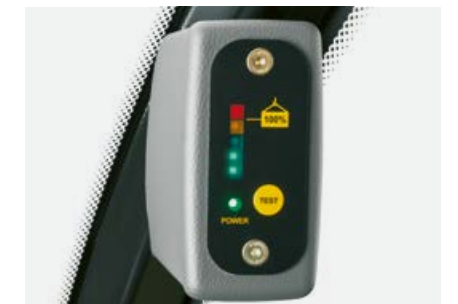
Отображение нагрузки с однозначными символами светофора: если предел стабильности превышен, все диоды загораются и раздается звуковой сигнал.
