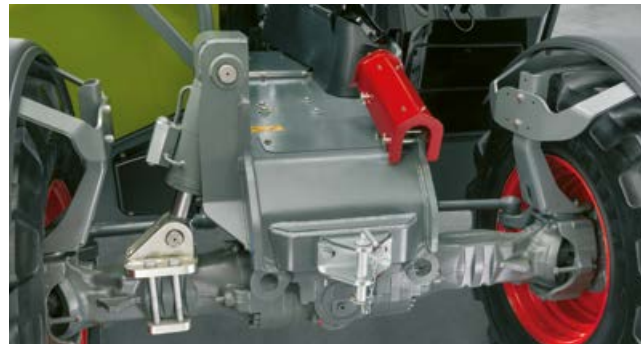
Повышенная безопасность на местности благодаря гидравлической корректировке уровня
