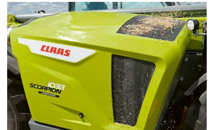
Минимальное загрязнение радиатора благодаря реверсивному вентилятору.
