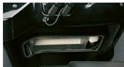
Удобный доступ к фильтру приточного воздуха в кабине.
