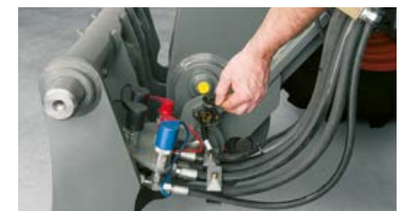
Розетки для гибкой подачи питания на различные навесные и прицепные орудия.
