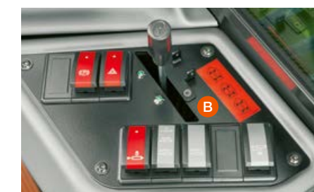
Поворотной-нажимной переключатель (А) для выбора типа рулевого управления в моделях SCORPION VARIPOWER.
