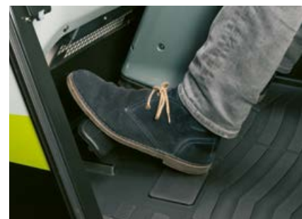
Педаля тормоза с функцией замедленного движения снижает расход топлива и износ тормозов.
