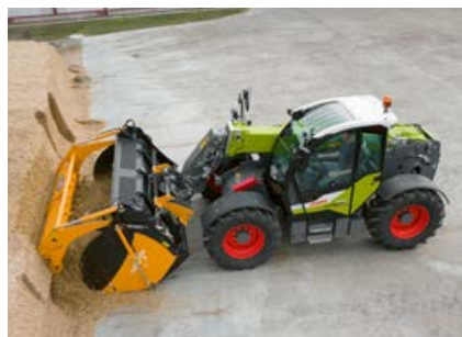
Автоматический возврат ковша для более быстрого выполнения работ вблизи земли.
