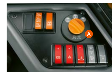
Поворотной-нажимной переключатель (А) для выбора типа рулевого управления в моделях SCORPION VARIPOWER.
