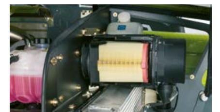
Воздушный фильтр двигателя легко доступен и не требует инструмента для технического обслуживания.
