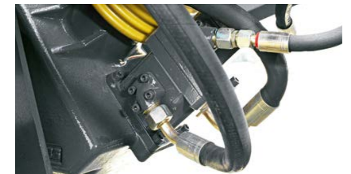
Два масляных насоса снабжают гидравлическим маслом входной редуктор и систему очистки узловзателей TURBO FAN.
