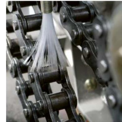
Надежность в эксплуатации. На всех прессах ROLLANT приводные цепи автоматически смазываются при каждом закрытии задней крышки и отличаются чрезвычайной прочностью.
