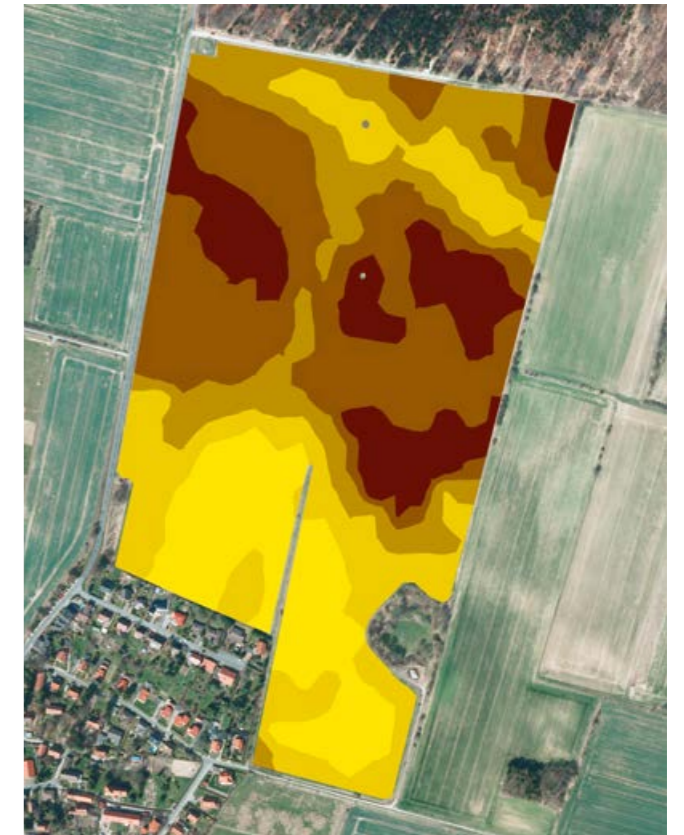
EM 38 – картирование почвы
