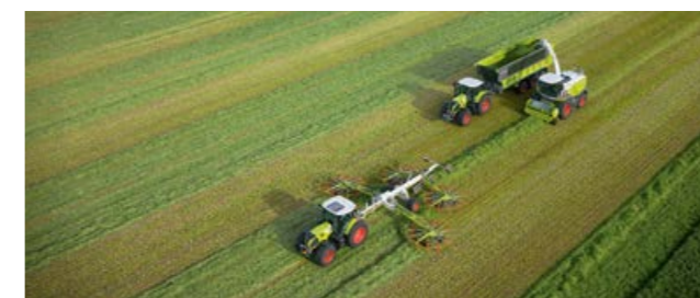
Чтобы обеспечить достаточную загрузку JAGUAR материалом, компания CLAAS в 1998 г. разработала первый в мире четырехроторный валкователь. Сегодня выпускается две модели таких машин, которые отличаются высочайшей производительностью в сегменте профессиональной техники.
