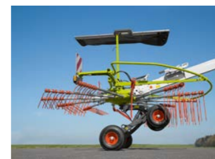
Большая высота подъема для переезда валков на краю поля: до 50 см в LINER 700 TWIN.
