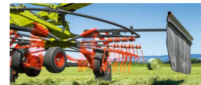
Уникальная конструкция рамы валкоукладчиков CLAAS с боковой укладкой позволяет устанавливать высоту подъема до 70 см.
