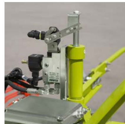
Оба четырехроторных валкователя доступны в версии повышенного комфорта с электрогидравлическим регулированием высоты подбора.
