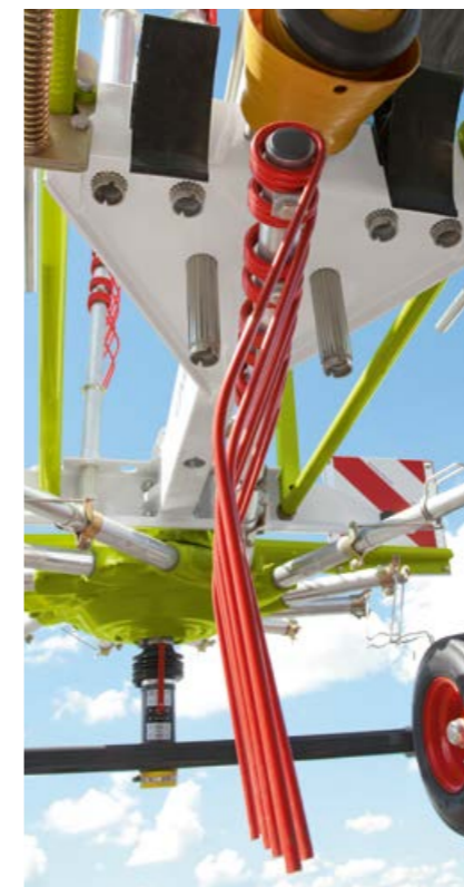
Стандартные 9-миллиметровые граблины в моделях 450, 420, 370 и 320 чрезвычайно прочны и подходят для заготовки как сенажа, так и сена.
