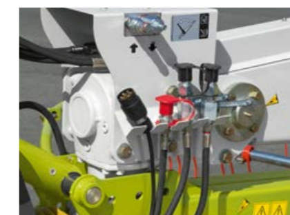
Серийное гидравлическое последовательное управление для настройки времени смещения между передним и задним ротором при поднятии и опускании.
