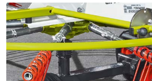
Соединение с помощью лимонобразного профиля и зажимных шплинтов в LINER 370 и 320.
