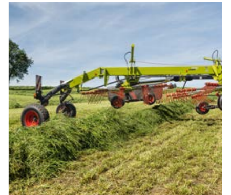
Аккуратные валки даже на краю поля благодаря максимальной высоте подъема.
