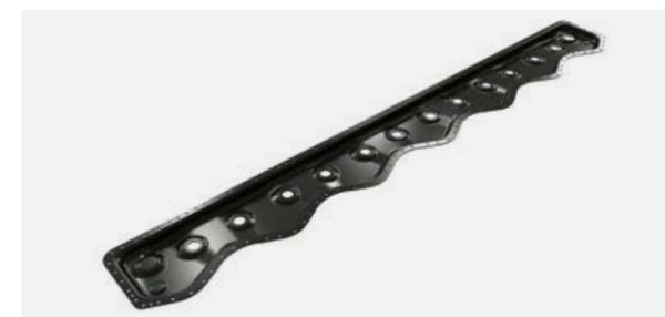
За специальную конструкцию корпуса из легированной мелкозернистой конструкционной стали и отказ от ослабляющих сварочных швов косилочный брус MAX CUT удостоен награды за инновационные решения из стали в 2018 г.
