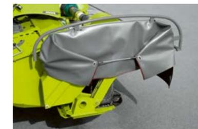
Благодаря низкорасположенному центру вращения DISCO PROFIL копирует рельеф почвы, а не движения трактора.
