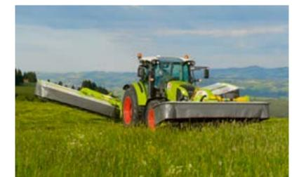
Благодаря компактной установке на переднюю навеску косилка располагается высоко при поворотах.
