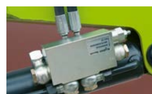
Благодаря электрическому переключению из кабины предохранительные клапаны погрузчиков серий FL и FL C комбинируются с функцией гашения колебаний SHOCK ELIMINATOR.
