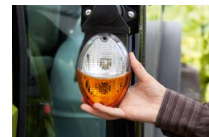
Складывающиеся габаритные фонари NEXOS VE предотвращают повреждение растений.
