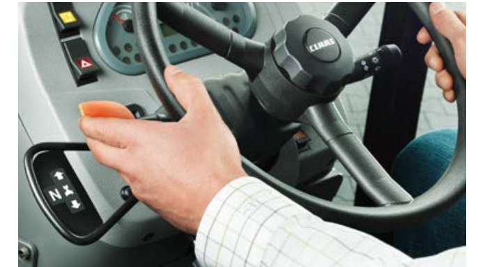
1 Рычаг REVERSHIFT для быстрых и удобных маневров с разворотами, особенно на краю поля или при штабелировании ящиков
