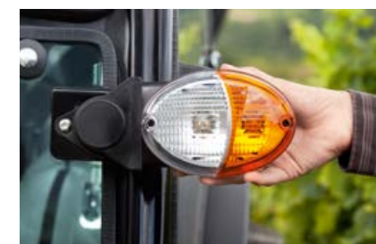
Складывающиеся габаритные фонари NEXOS VE предотвращают повреждение растений.
