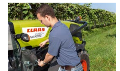
Дуга безопасности складывается моментально без использования инструмента.
