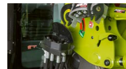
Мультисцепка MACH – самый быстрый способ осуществить соединение.
