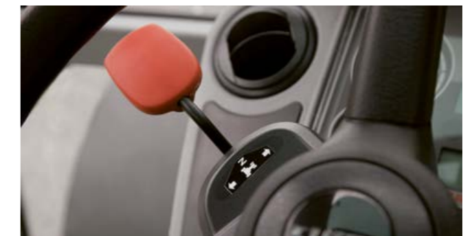
Механизмом реверсирования REVERSHIFT механизатор управляет кончиками пальцев.
