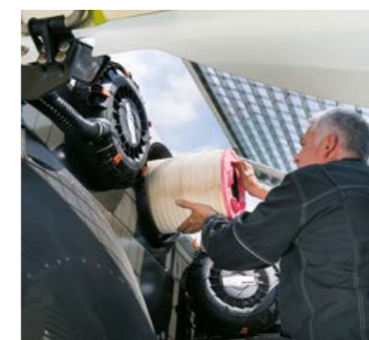
Замена воздушного фильтра без использования инструментов
