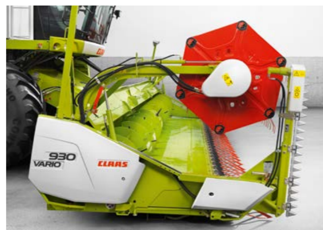
Стол жатки выдвинут – с рапсовым ножом (+600 мм).
