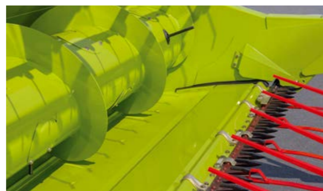
Стол жатки выдвинут – уборка зерновых (+100 мм).
