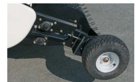
Копирующие колеса ограничивают глубину.
