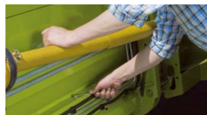
Регулируемые снаружи скребки (С 490, С 430, С 370).
