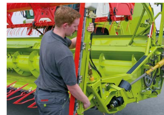
Установка рапсовых ножей с помощью быстродействующего затвора.
