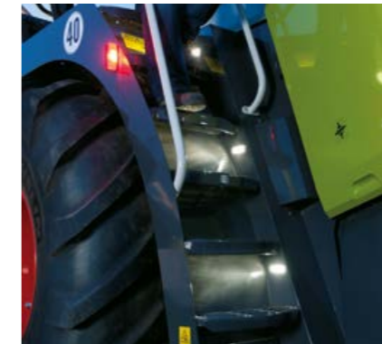
Светодиодная подсветка ступеней обеспечивает безопасный подъем в комфортабельную кабину.
