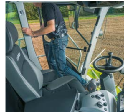
Датчик сиденья автоматически выключает приставку и главный привод.
