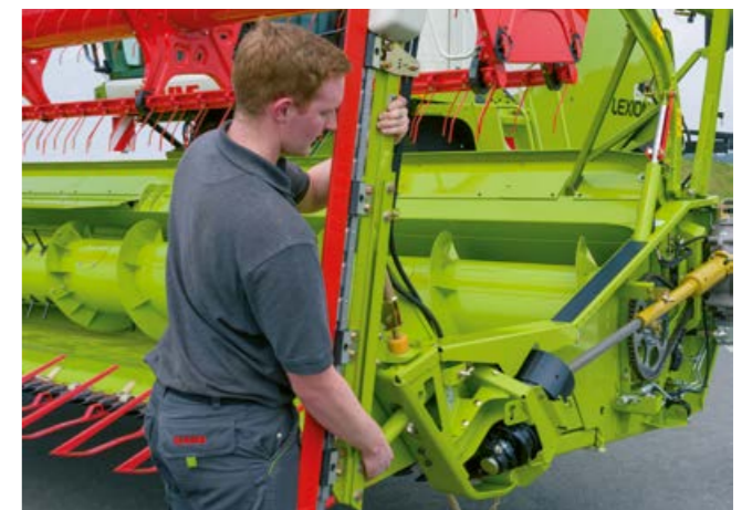
Установка рапсовых ножей с помощью быстродействующего затвора.
