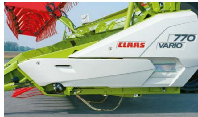
Скобы-копирсы определяют положение жатки непосредственно за режущим аппаратом.
