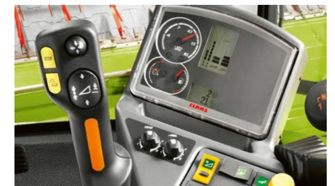
Кнопка регулировки высоты на многофункциональном джойстике позволяет с легкостью включить AUTO CONTOUR.
