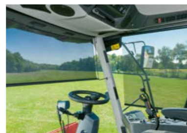
Электрическая система регулирования зеркала заднего вида и боковых шторок для оптимальной видимости.
