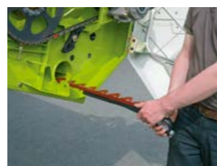
Запасной нож встроен в жатку снизу.
