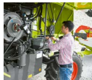
Большие боковые капоты для удобного доступа.
