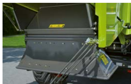
Простая перестройка с измельчения на укладку валка.
