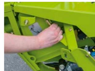
Блокировка стеблелimiters и рапсовых ножей без инструмента с помощью быстроразъемного замка.
