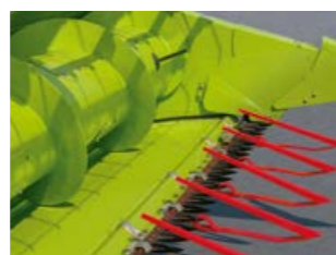
Стол жатки задвинут – уборка зерновых (-100 мм).
