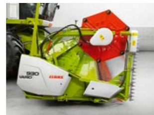
Стол жатки задвинут – с рапсовым ножом (+450 мм).
