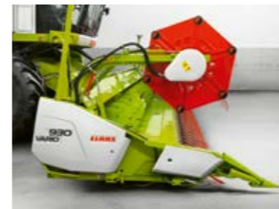
Стол жатки выдвинут – уборка зерновых (+600 мм).
