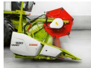
Стол жатки задвинут – уборка зерновых (–100 мм).
