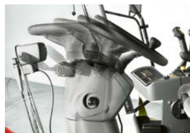
Рулевая колонка регулируется в 3 направлениях.
