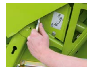
Блокировка стебледелителей без инструмента с помощью быстроразъемного замка.
