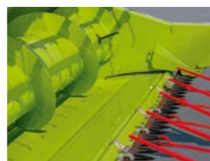
Стол жатки выдвинут – уборка зерновых (+100 мм).
