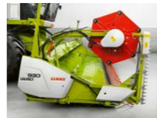
Стол жатки выдвинут – с рапсовым ножом (+600 мм).
