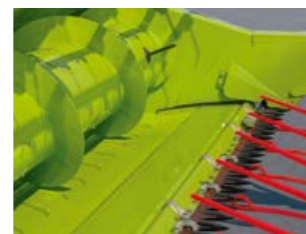
Стол жатки выдвинут – уборка зерновых (+100 мм)
