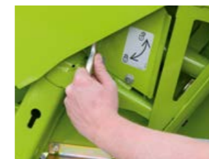
Блокировка стебледелителей без инструмента с помощью быстрогодействующего затвора
