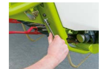
Простая регулировка стебледелителя по высоте с помощью складного ключа
