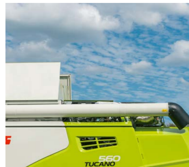
Боковые отверстия для выпуска воздуха для повышения эффективности охлаждения
