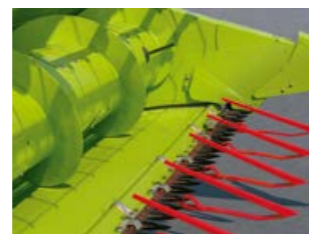
Стол жатки задвинут – уборка зерновых (-100 мм)
