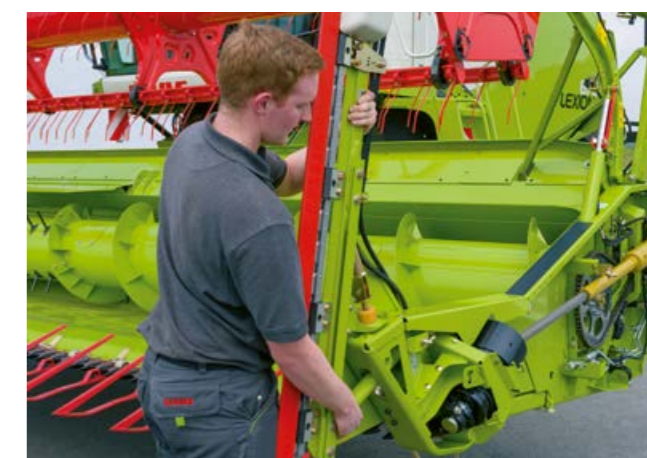
Установка рапсовых ножей с помощью быстродействующего затвора
