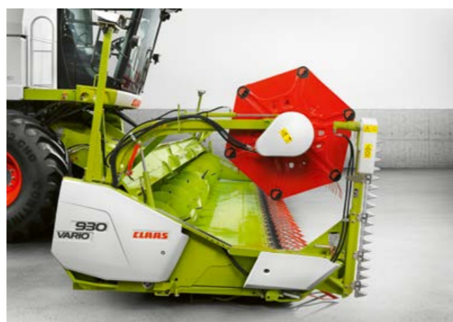
Стол жатки выдвинут – с рапсовым ножом (+600 мм)
