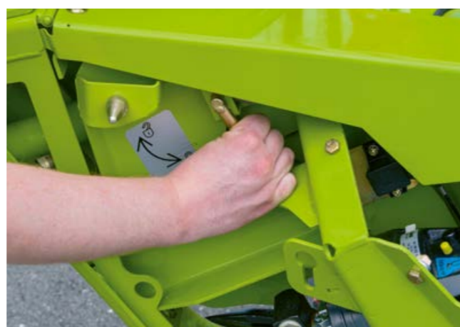
Блокировка стеблелителей и рапсовых ножей без инструмента с помощью быстродействующего затвора
