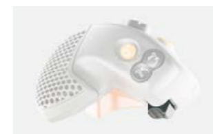
Регулировка стола жатки VARIO, ножевого бруса MAXFLEX и скорости транспортера MAXFLO на многофункциональном джойстике CMOTION
