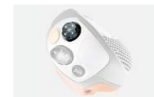
Регулировка стола жатки VARIO, ножевого бруса MAXFLEX и скорости транспортера MAXFLO на многофункциональном джойстике CMOTION
