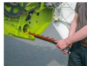
Зарезанный нож встроен в жатку снизу
