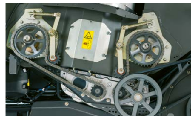
Редуктор системы выгрузки производительностью 180 л/с.
