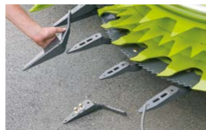
Демонтируемые направляющие пальцы улучшают подъем полеглая кукурузы
