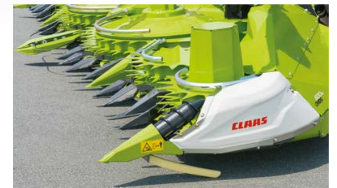
В случае необходимости предусмотрен гидравлический привод шнеков для полеглой кукурузы
