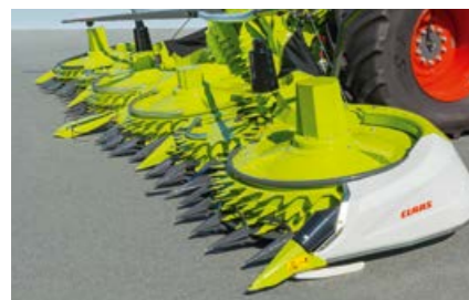
Чрезвычайно плоская конструкция для очень низкой высоты стерни
