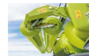
Роликовые прижимы для идеального потока массы
