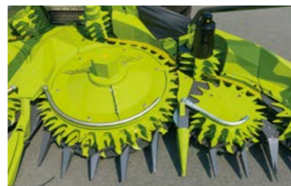
Безопасная транспортировка растительной массы через специальные каналы
