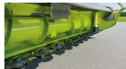
DIRECT DISC 600/500 с подающим шнеком большого размера
