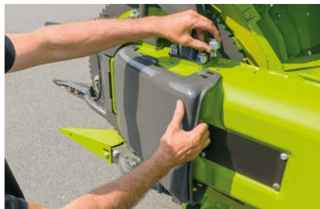
Скользящие башмаки с двухступенчатой регулировкой по высоте
