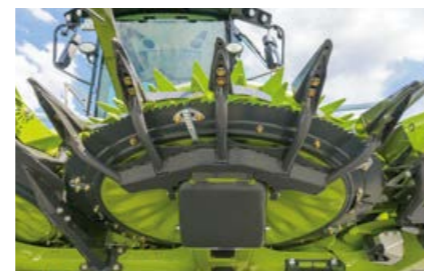
Прочные направляющие пальцы и очистители под дисковым ножом для аккуратной работы
