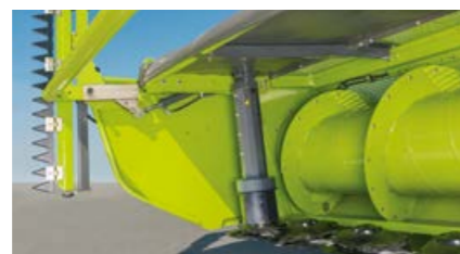
Регулируемые прижимы, опционально также гидравлические.
