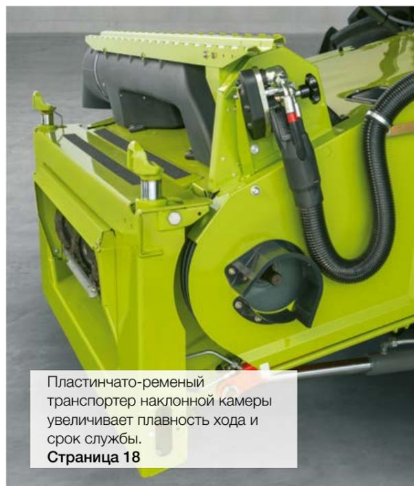
Пластинчато-ременный транспортер наклонной камеры увеличивает плавность хода и срок службы.
