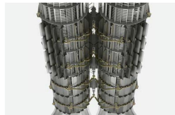
**Гидравлическая регулировка заслонок ротора.**
