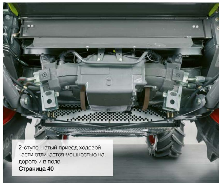
2-ступенчатый привод ходовой части отличается мощностью на дороге и в поле.
