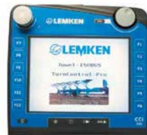
**TurnControl Pro\*** – это совместимое с ISOBUS полностью электронное решение по управлению для Juwel 8 V. В серийной комплектации оно обеспечивает автоматический оборот плуга, а также регулировку угла наклона, ширины захвата и глубины обработки. При желании объем функций можно расширить.
