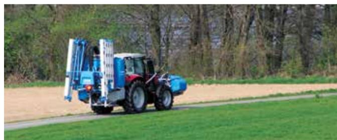
Передние баки наиболее удобны при движении по узким дорогам или в холмистой местности, поскольку, несмотря на большой объем бака, машина остается компактной и на дорогу затрачивается меньше времени.
