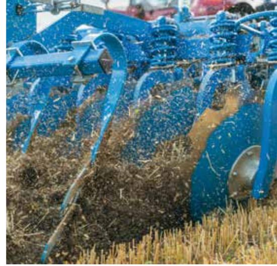
До настоящего момента короткие дисковые бороны обеспечивали интенсивное и равномерное перемешивание органической массы и почвы на рабочую глубину до 14 см.
